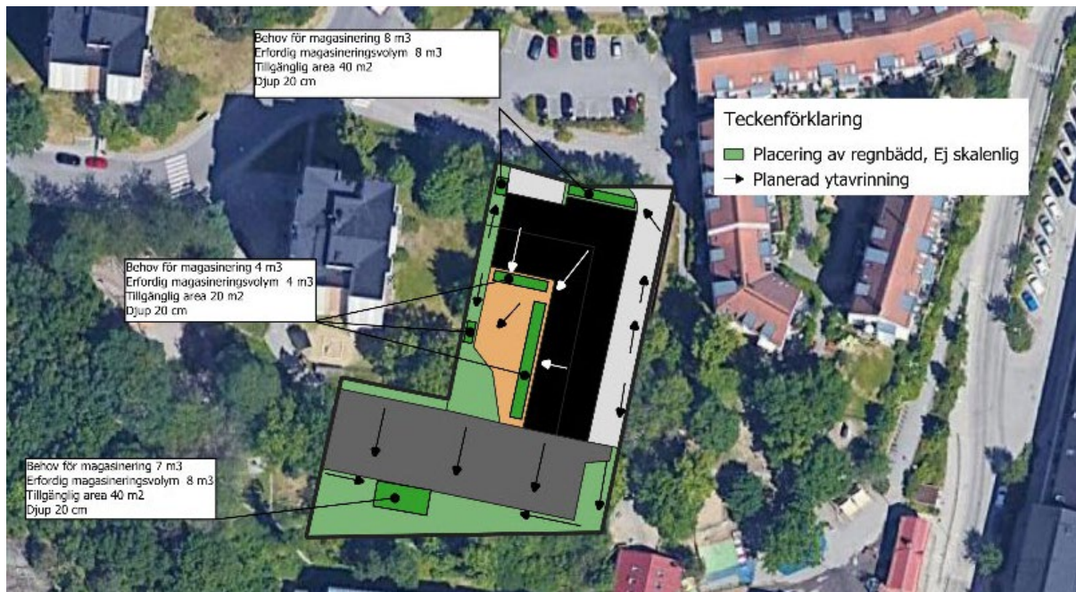
Figur 16: Bilden visar erforderliga ytor för fördröjning och rening av dagvatten. Bild av Rejlers.
